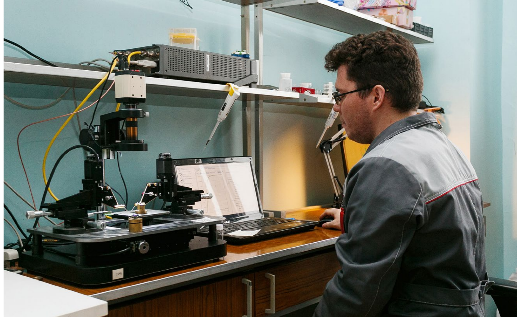
Научный сотрудник Аскольд Труль измеряет электрические характеристики органических полевых транзисторов
